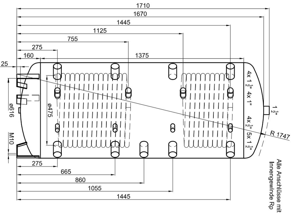
Alle Anschlüsse mit Innengewinde Rp
